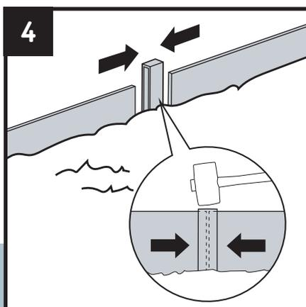
4 É possível inserir as extremidades das bordas em um perfil de fixação. Isso não é obrigatório, mas cria uma transição estável e uniforme. Ângulos arredondados podem ser feitos cortando a borda e posicionando-a uma contra a outra no ângulo desejado.
