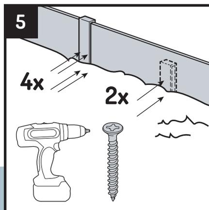
5 Bata delicadamente a borda na altura desejada usando um martelo de borracha. Parafuse as estacas de fixação na borda usando 2 parafusos de aço inoxidável de 4 x 30 mm. Fixe com 4 parafusos qualquer estaca de fixação usada como transição entre dois perfis.
