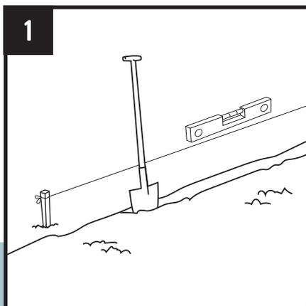
1 Cave um canal. Certifique-se de que pelo menos metade da borda possa desaparecer no canal. Para bordas retas, marque a linha ao longo da qual o Multi-Edge ECO deve ser instalado usando cordas e estacas.
