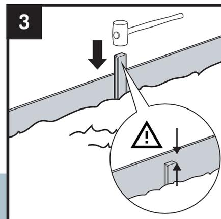
3 Posicione as estacas de fixação a intervalos de 50 cm ao longo da borda. Afunde-as no solo usando um martelo de borracha. Certifique-se de que as estacas de fixação fiquem a alguns centímetros abaixo da borda superior da borda. Depois de instaladas, as estacas de fixação não serão mais visíveis.
