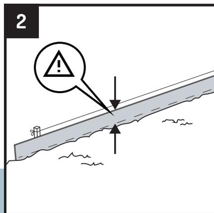
2 Posicione a borda no canal. Certifique-se de que pelo menos metade da borda esteja enterrada. A borda ficará ainda mais estável se for inserida mais profundamente no solo. Corte qualquer excesso de comprimento da borda usando uma serra manual para madeira.
