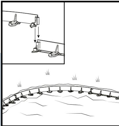
Coloque a borda no local desejado. Deslize as extremidades uma na outra para conectar as bordas. O comprimento excedente pode ser cortado com uma serra manual para madeira.
