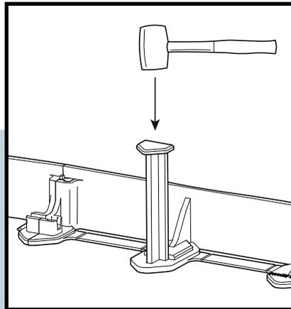
Fixe a borda batendo cuidadosamente as estacas no solo com um martelo. Para uma borda estável, use todas as estacas fornecidas.
