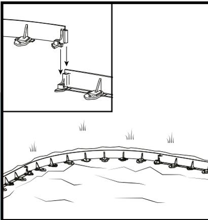
Coloque los bordes en el lugar deseado. Deslice los extremos de los bordes de arriba a abajo para conectarlos. El exceso de longitud se puede cortar con una sierra para madera.
