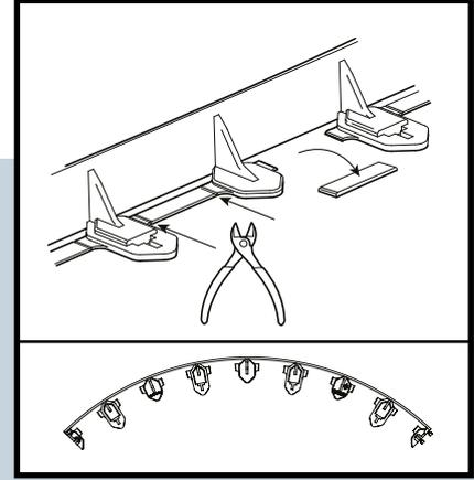
Retire los conectores con un alicate de corte para crear formas curvas o redondas.
