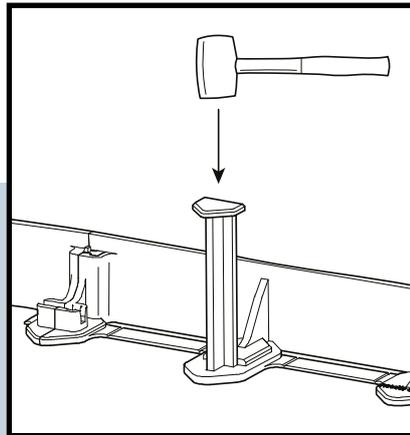
Con la ayuda de un martillo clave las estacas con cuidado. Utilice todas las estacas incluidas en el paquete para una estabilidad óptima.
