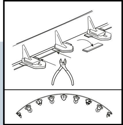
Entfernen Sie mit einer Zange die Verbindungsstücke zwischen den einzelnen Segmenten, um eine Rundung oder Kurve zu bilden.
