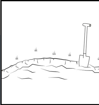
Markieren Sie die gewünschte Form und eben Sie den Boden/ Untergrund. Einen Rasenrand stechen Sie mit einem Spaten ab.
