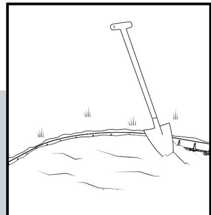
Die Seiten der Rasenkante füllen Sie nun mit dem gewünschten Material auf. Bedecken Sie die Seiten, bis noch etwa ein paar Millimeter von der Rasenkante über dem Grund zu sehen sind.
