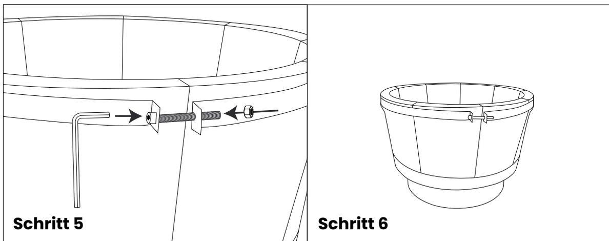
Ziehen Sie die Verbindungsschraube leicht an.
