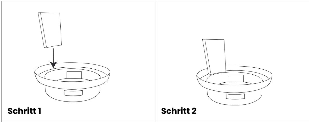
Legen Sie die perforierte Metallschale auf den Boden.
