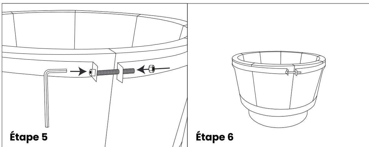
Serrer légèrement le boulon d'assemblage.
