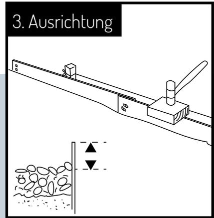
Klopfen Sie die Rasenkante mit Hilfe eines Holzblockes auf die gewünschte Höhe. Stellen Sie sicher, dass etwa die Hälfte über dem Boden sichtbar ist, um optimale Stabilität zu gewährleisten.
