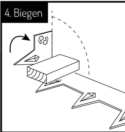
Mit Hilfe eines Holzblockes oder einer Werkbank (bitte bei Verwendung eines Schraubstockes, Holzblöcke verwenden zur Vorbeugung von Kratzern) können Sie die Rasenkante in den gewünschten Winkel biegen. Kreisförmige oder gewellte Formen gestalten Sie freihändig.
