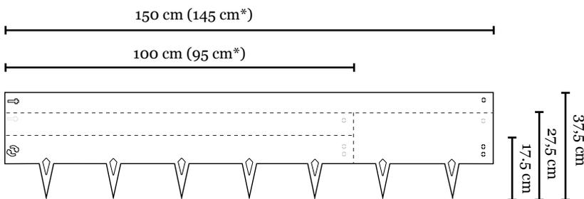
\*Arbeitslänge. Um zu berechnen, wie viele Rasenkanten Sie benötigen, rechnen Sie bitte mit einer Länge von 0,95 oder 1,45.
