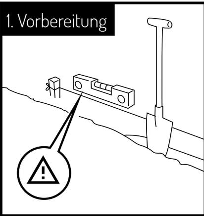
Markieren Sie die gewünschte Form (gerade, Kreis oder ähnliches) mit Hilfe eines Seils und Pflöcken. Stechen Sie mit einer Schaufel ungefähr 8 cm in den Boden. Dadurch kreieren Sie eine Führung für die Rasenkante.
