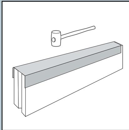
Die Verarbeitung der Profile ist sehr einfach. Legen Sie ein Profil über den Bordstein. Ein weiteres Profil oder Eckstück dicht ansetzen, sodass keine Kanten des Bordsteins mehr sichtbar sind.
