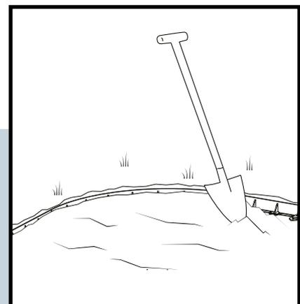
Finissez la bordure en complétant la surface avec le matériau souhaité. Recouvrez la bordure jusqu'à ce qu'elle dépasse de quelques millimètres encore la surface.
