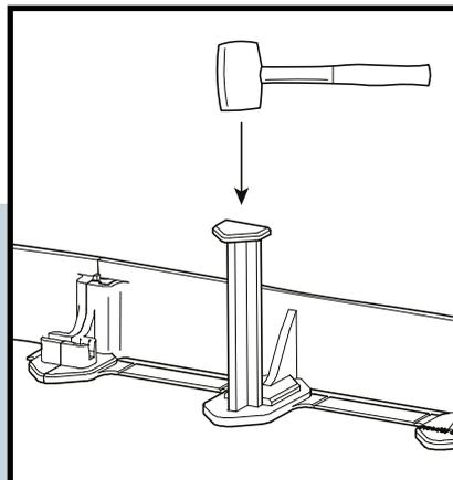
Sécurisez la bordure en tapant doucement sur les piquets à l'aide d'un marteau pour les enfoncer dans la terre. Utilisez tous les piquets fournis pour une bordure stable.
